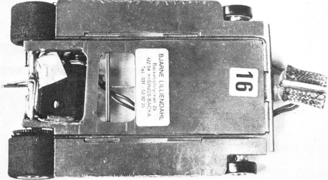
Bjarnes bil. Givetvis eget chassi, av experimentmodell. Mittensektionen gjord i kopparbronsplåt.
